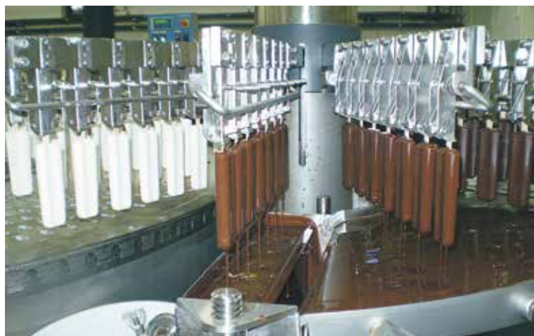
Namáčení nanuků do polevy. Když se nanuk ponoří do kakaové polevy, má teplotu -12 °C. Díky tomu poleva okamžitě zatuhne.
