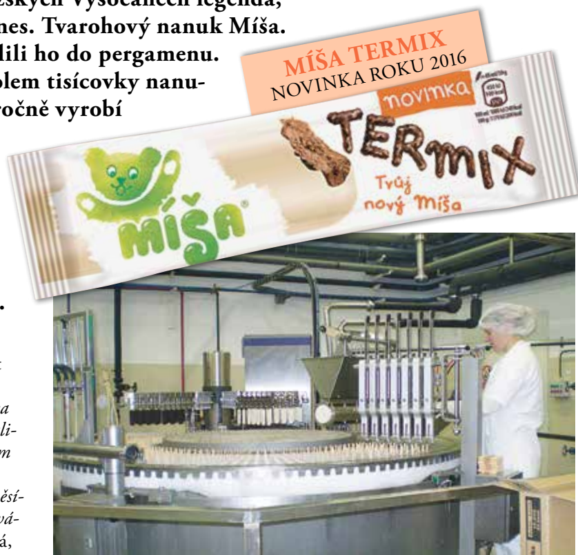
Kolo s plničkou. Na jednom stroji se průběžně plní 800 stejných formiček. Na začátku se formičky zchladí na -40 °C.
